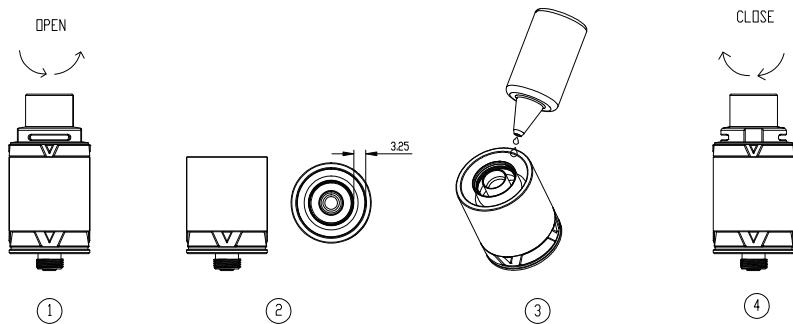
5 Cambia l' atomizzatore: Svitare la base per rimuovere, semplicemente, e inserisci un' atomizzatore nuovo quando necessario. Estrai EUC fuori dalla base e inserisci uno nuovo. Aspetta dopo una sostituzione per assicurarsi che la coil sia innescata bene.
