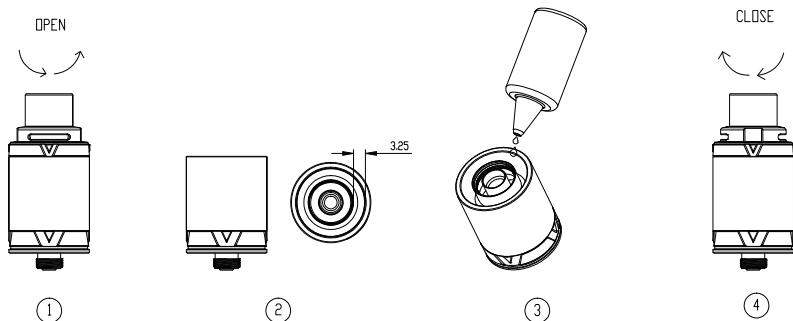
5. Cambio de atomizador: Desenroscar simplemente la base para eliminar e insertar un nuevo atomizador cada vez que sea necesario. Tire de la EUC hacia fuera de la base y coloque una nueva. Tornillo de la Base en. Espera después de cambiar para asegurarse de que la bobina está bien cebada.
