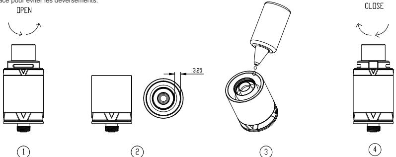
5. Changement d'atomiseur: Dévissez la base pour simplement retirer et insérer un nouvel atomiseur chaque fois que nécessaire. Tirez le EUC à partir de la base et insérez un nouveau. Vissez la base. Attendez après le remplacement pour vous assurer que la bobine est bien amorcée.
