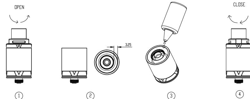
5. Skiftende Forstørre: Afmonter basen til du bare fjerner og indsæt et ny atomizeren når det er påkrævet. Træk EUC ud fra basisdelen og sæt en ny Skru Base på. Vent efter udskiftning af at være sikker på tændspole er godt spændet.
