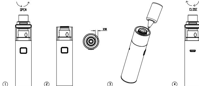
4. Modificare Atomizer: Svitare il serbatoio dalla base per rimuovere ed inserire un nuovo atomizzatore. Estrarre EUC fuori dalla base e inserire una nuova.
