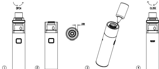
4. Skiftende Forstøver: Skru beholderen fra basen for at fjerne og indsætte en ny forstøver. Træk EUS ud fra basen og sæt en ny. Skru på Basen. Vent efter udskiftning for at sikre, at spolen er godt spædet.
