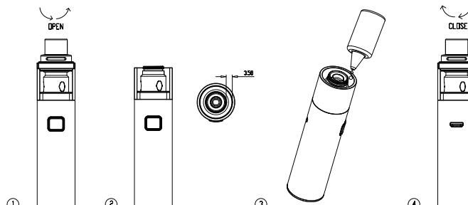
4. Zerstäuber wechseln: Schrauben Sie den Behälter von der Basis ab, um einen neuen Zerstäuber zu entfernen und einzustecken. Ziehen Sie den EUC aus der Basis und stecken Sie einen neuen ein.
