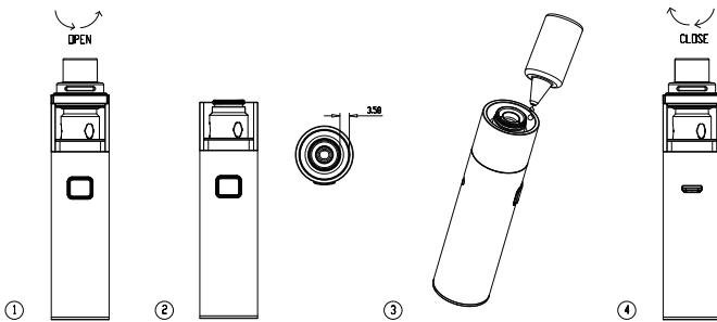
4. Verdamer vervangen: Schroef de tank van de basis om een verdamer(coil) te verwijderen en/of te vervangen door een nieuwe. Haal de EUC uit van de basis en zet er een nieuwe in.
