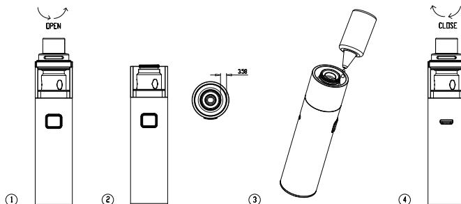
4. Evaporateur remplacé: dévissez le réservoir à partir de la base afin d'éliminer un évaporateur (bobine) et / ou de le remplacer par un nouveau. Retirez le EUC de la base et de mettre un nouveau.
